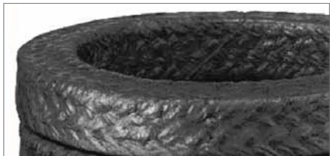
**Merkel Uniflex** изготавливается из карбонизированных волокон со специальной ПТФЭ-графитовой пропиткой. Набивка эластичная и устойчивая к экструзии. Благодаря особой технологии пропитки не вымывается из волокон на протяжении всего срока службы набивки. Термическая и объемная стабильность позволяют достигать превосходного результата уплотнения при минимальных усилиях сжатия. Благодаря этим свойствам Merkel Uniflex используется для случаев работы без смазки.
