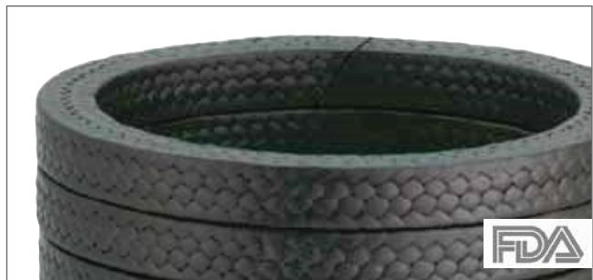
**Merkel Unival** производится из ПТФЭ-пряжи с графитовым наполнением и специальной смазкой. Благодаря особой структуре плетения набивка обладает низким тепловым расширением и превосходной теплопроводностью. Низкий коэффициент трения позволяет в определенных пределах работать набивке Merkel Unival в сухую, а сочетание пластичности и плотности дает великолепный уплотняющий эффект даже при минимальном усилии сжатия.
