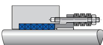
Необслуживаемое уплотнение. Создаваемое пружиной усилие должно превышать давление рабочей среды!
