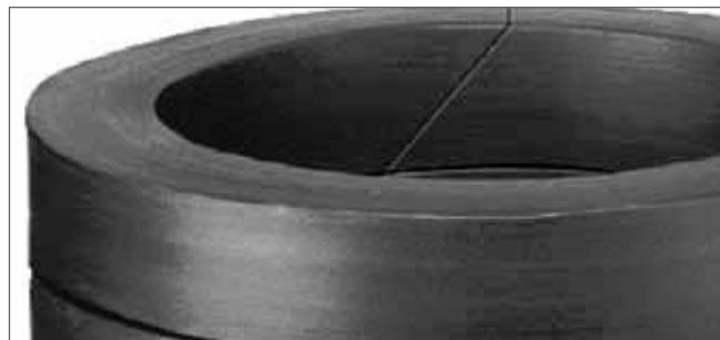
Компактная экструдированная набивка из ПТФЭ-графитового компаунда. Merkel Univerdit обладает очень хорошей сопротивляемостью к прониканию газов и абразивной стойкостью. Merkel Univerdit сохраняет свойство самосмазывания даже после длительного периода эксплуатации, а потому уменьшает трение на валах и шпинделях. Как правило, Merkel Univerdit устанавливается с концевыми кольцами.\*
