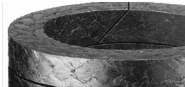
**Merkel G-Spezial** изготавливается из термостойкой гибкой графитовой пряжи, армированной тонкой инконелевой проволокой. Эта устойчивая к высокому давлению плетеная набивка обладает такими же исключительными уплотняющими характеристиками, как и формованные кольца из чистого графита.
