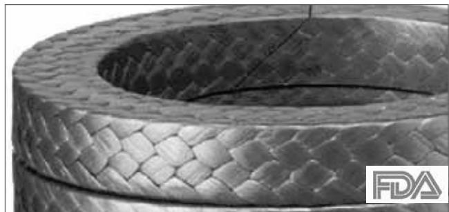
**Merkel Unistat** производится из графитонаполненной ПТФЭ-пряжи. Высокое содержание графита обеспечивает превосходную теплопроводность, в то время как ПТФЭ дает низкий коэффициент трения. Благодаря своей плотной и устойчивой к давлению структуре Merkel Unistat находит широкое применение в плунжерных насосах, а превосходная стойкость к различным химическим средам делает эту набивку незаменимой для химической промышленности.
