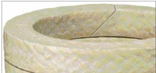
**Merkel Arolan II** изготавливается из износостойких арамидных волокон с особой пропиткой политетрафторэтиленом и универсальной антифрикционной смазкой. Высокая абразивная стойкость, а также устойчивость к широкому диапазону температур и химических сред, делают *Merkel Arolan II* универсальной набивкой для многих отраслей промышленности.
