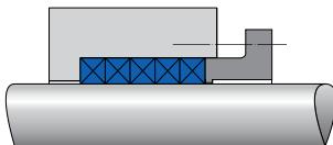
Базовая конструкция для арматуры, центробежных и плунжерных насосов
