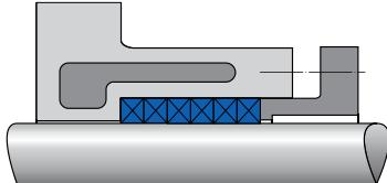
Для уплотнения валов со средой, имеющей температуру кипения ниже рабочей температуры
