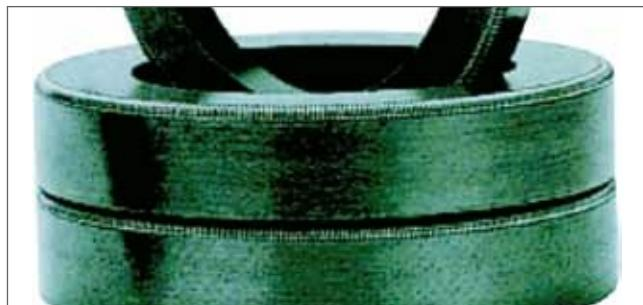
**Merkel Grafiflex Уплотнения крышек** поставляются в виде формованных колец и уже не единожды продемонстрировали свои преимущества особенно в клапанах, работающих в тяжелых условиях, и в подогревателях питательной воды, работающих при высоких давлениях. Merkel Grafiflex сохраняет эластичность даже при колебании температур и нагрузках на поверхность до 200 Н/мм<sup>2</sup>. Конструкционные зазоры до 0.3 мм уплотняются без проблем.
